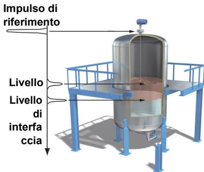
Impulsi a microonde di nanosecondi a bassa emissione vengono guidati lungo una sonda sommersa nel mezzo di processo. Quando un impulso a microonde raggiunge un mezzo con costante dielettrica differente, parte dell'energia viene riflessa al trasmettitore.
