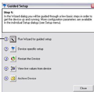
3. Fare clic sul pulsante **Run Wizard for guided setup** (Avviare l'impostazione guidata). Seguire le istruzioni per la configurazione di base per completare la procedura di installazione breve del trasmettitore.
