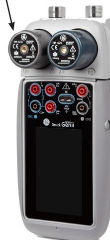
Misura della pressione con sostituzione dei sensori durante l'utilizzo, nei campi da 25 mbar (10 inH<sub>2</sub>O) a 1.000 bar (15.000 psi)
