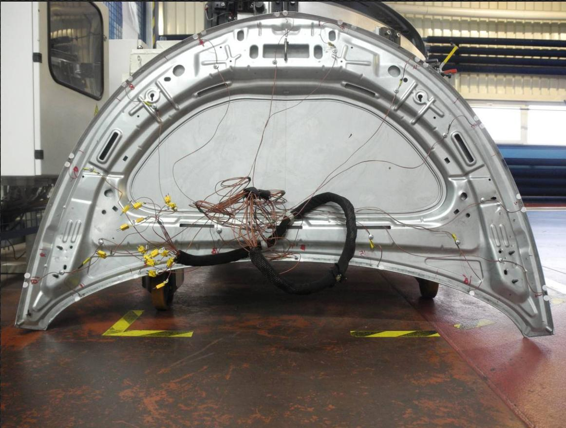
Prima di utilizzare la termocamera, come sistema di controllo delle temperature del sistema d'induzione, si utilizzava un cofano con saldate sedici termocoppie e si rilevavano i dati con un data logger. Tale processo era invasivo poiché creava interruzioni nella produzione e richiedeva un tempo lungo.
