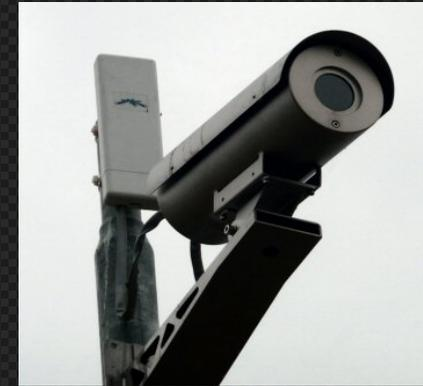
Le termocamere possono essere alimentate da pannelli fotovoltaici, ed essere dotate di trasmettitore Wi-Fi, per trasmissione immagini termiche alla sala controllo.
