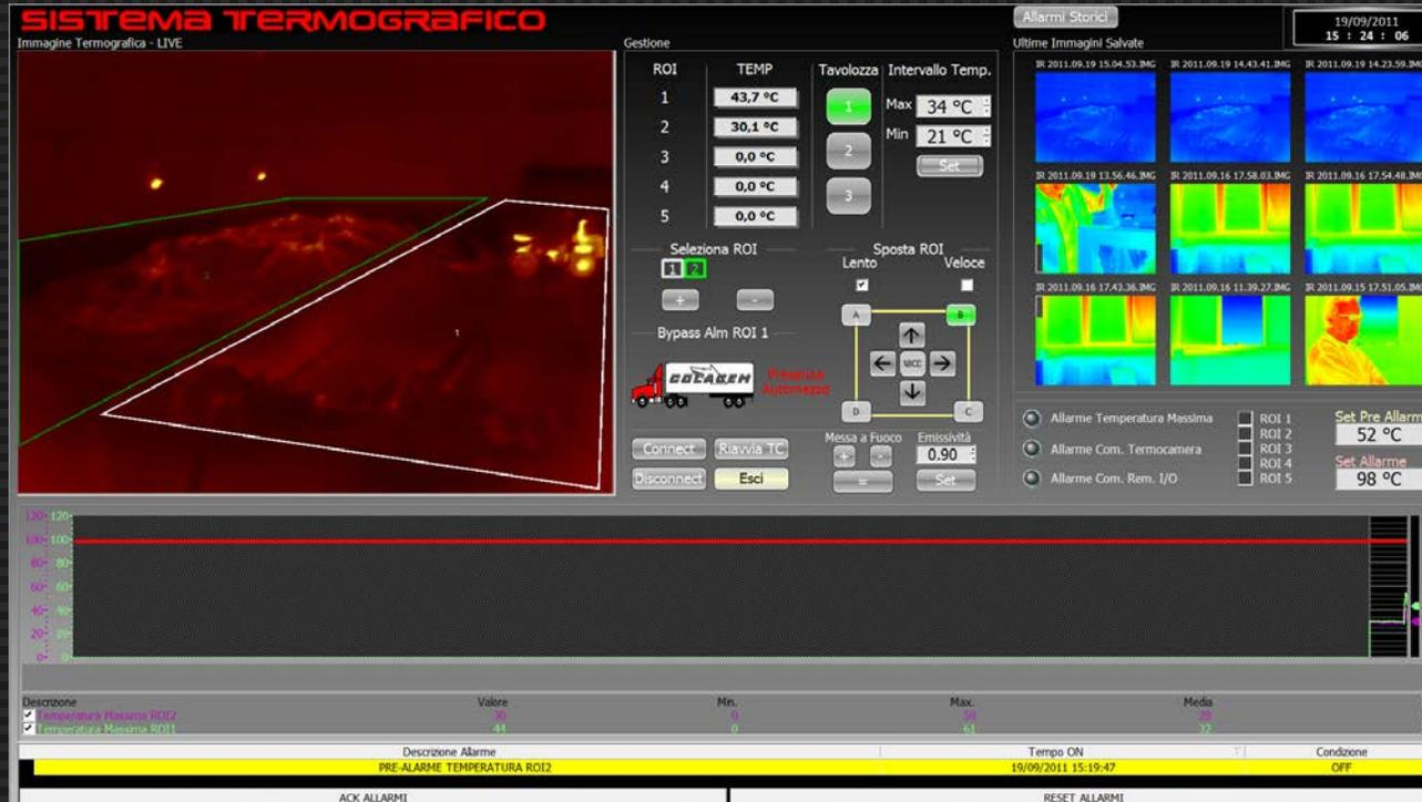
Sulla pagina grafica è possibile visualizzare l'immagine, impostare il valore di pre-allarme ed allarme, impostare il bypass e posizionare l'area di monitoraggio.
