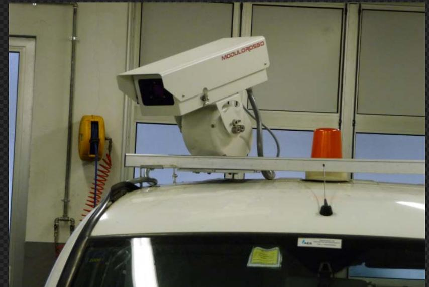
Termocamera installata sul tetto di un furgone, per ispezione reti teleriscaldamento.
