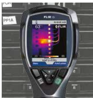
FLIR i3, temperatura su 3.600 punti
