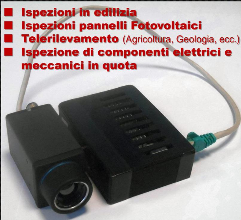
**Kit Drone Easy Fly 32 & 64** per termocamere FLIR A35 e A65 con sensore 320x256 e 640x512 pixels
