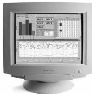
Per l'uso con modelli con uscita digitale RS-232 o RS-485, il Software DataTemp Multidrop software permette l'accesso alle caratteristiche digitali estese del termometro MID con un'interfaccia di semplice utilizzo. Compatibile con Windows 95/98/NT/2000, il DataTemp Multidrop permette il setup del sensore, il monitoraggio remoto, e la semplice memorizzazione dati per l'analisi o per incontrare le richieste di mantenimento, per il servizio qualità, delle memorizzazioni
